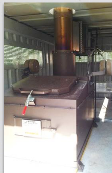
Modelul A850 cu recuperator de căldură, instalat în container
